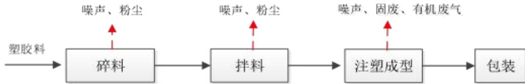
塑胶件生产工艺流程及产污环节图
