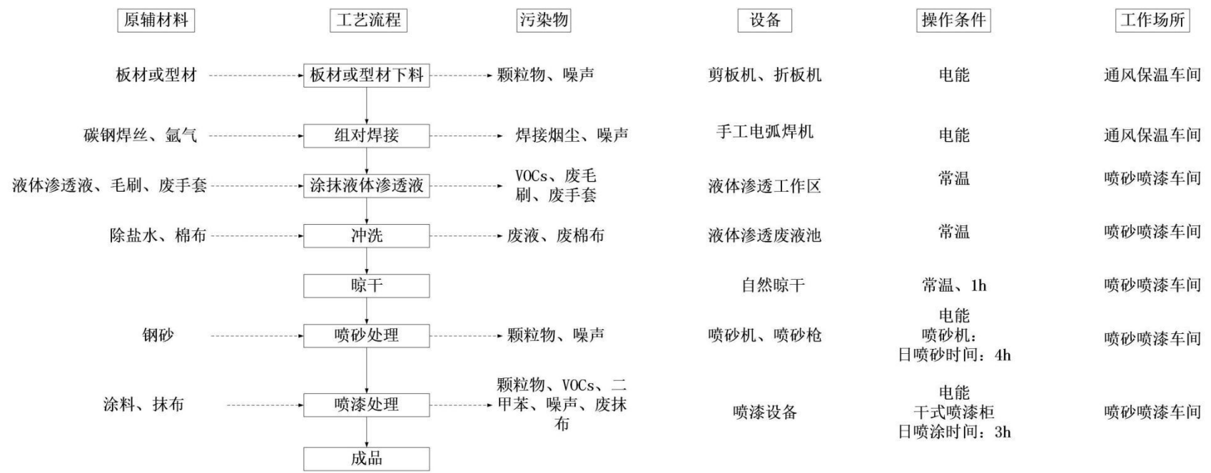
图 2-7 镀锌风管法兰（碳钢）工艺流程图
