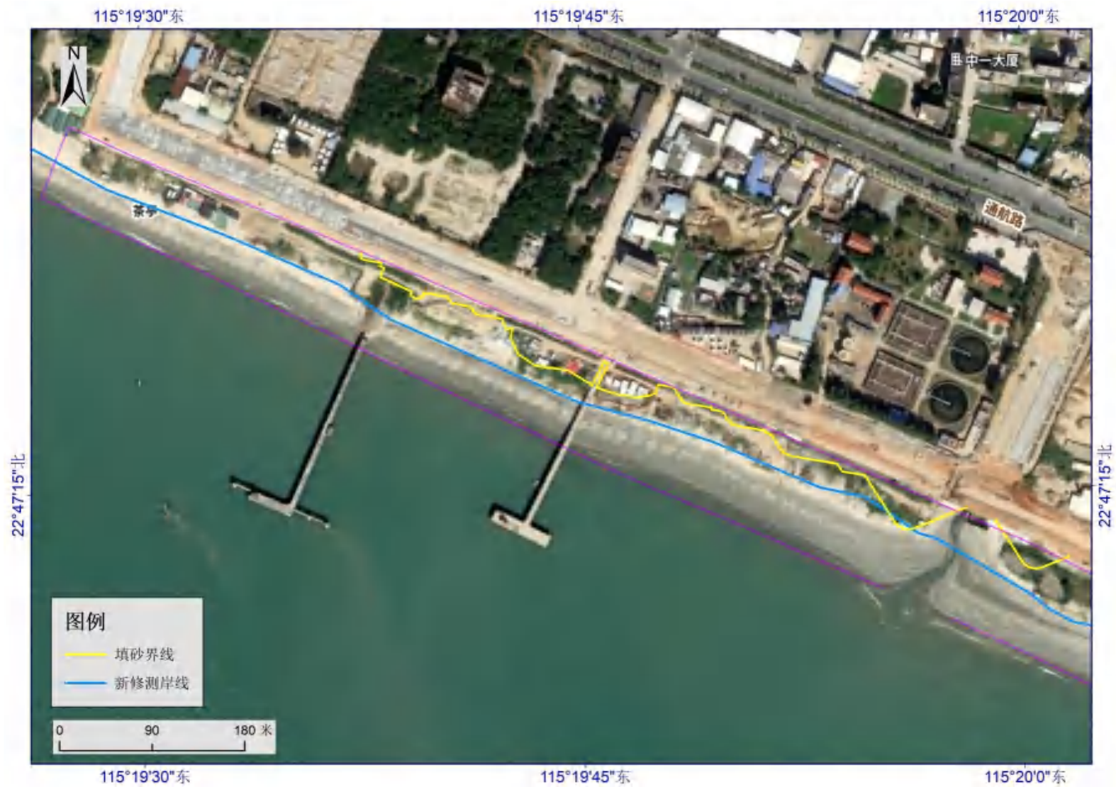
图 2.-5a 沙滩现状与新修测岸线的位置关系（西面约 900m 段）
