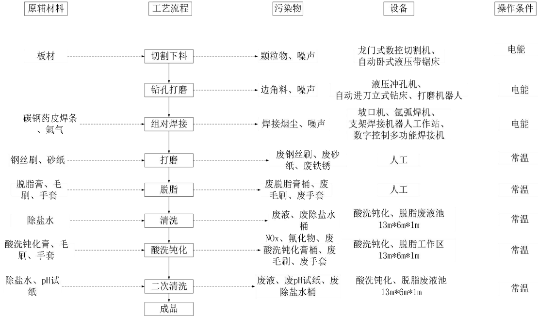
图2-10 EM8/9支架E1、E2预制工艺流程图
