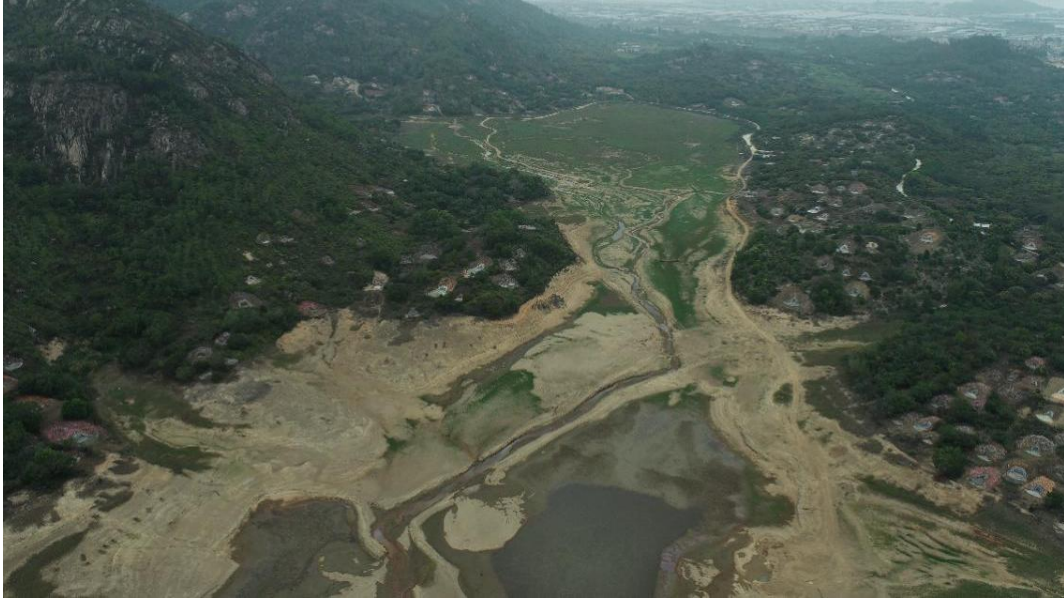
图 3.1-1 水库淤积现状
