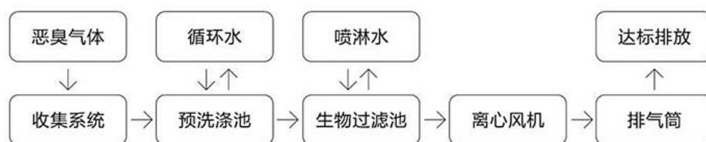
图 6.1-1 生物除臭系统工艺流程
