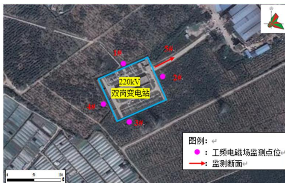
ZT1-图 8.1-1 东莞 220kV 双岗站监测布点图
