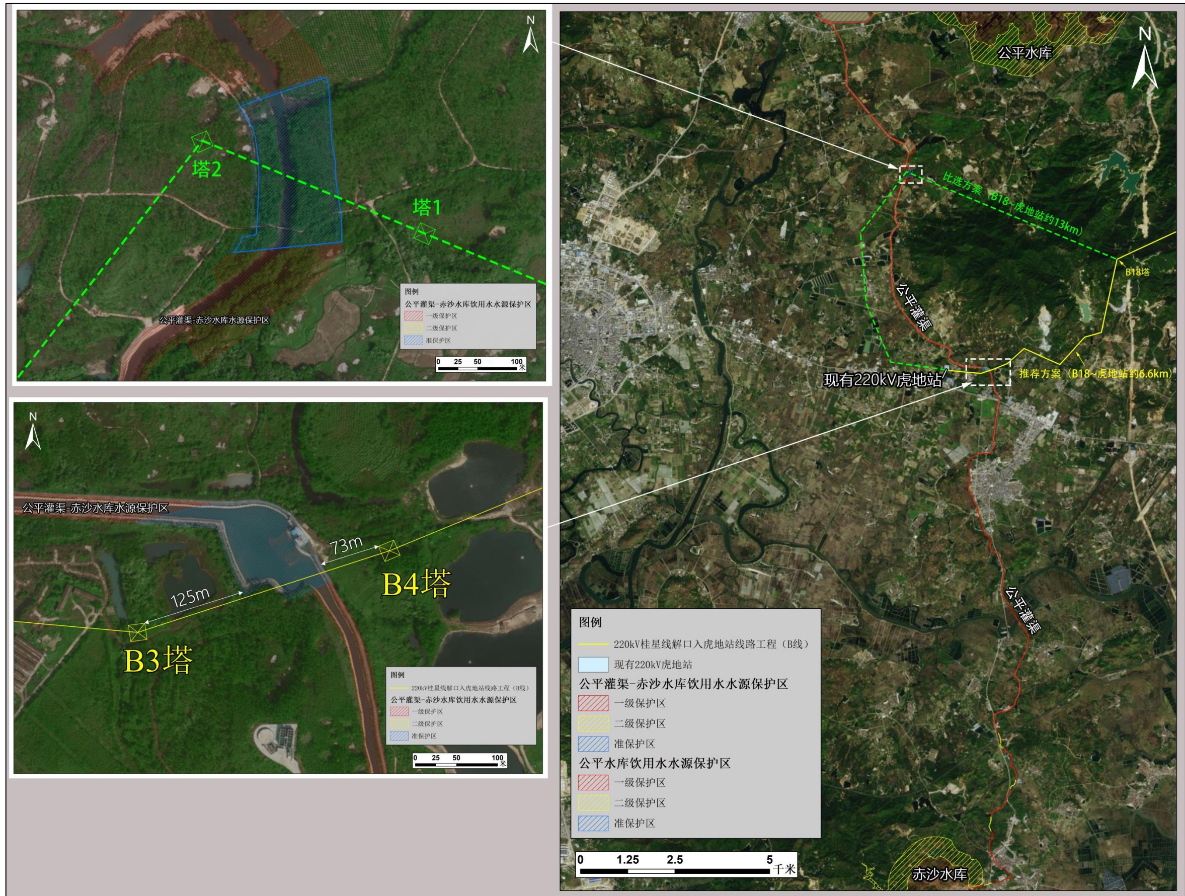
ZT2-图 7.1-1 本项目 B 线跨越海丰县公平灌渠-赤沙水库饮用水水源保护区的制约因素分布及比选情况图
