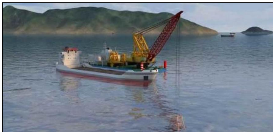
图 2-5 (a) 抓斗船施工示意图
