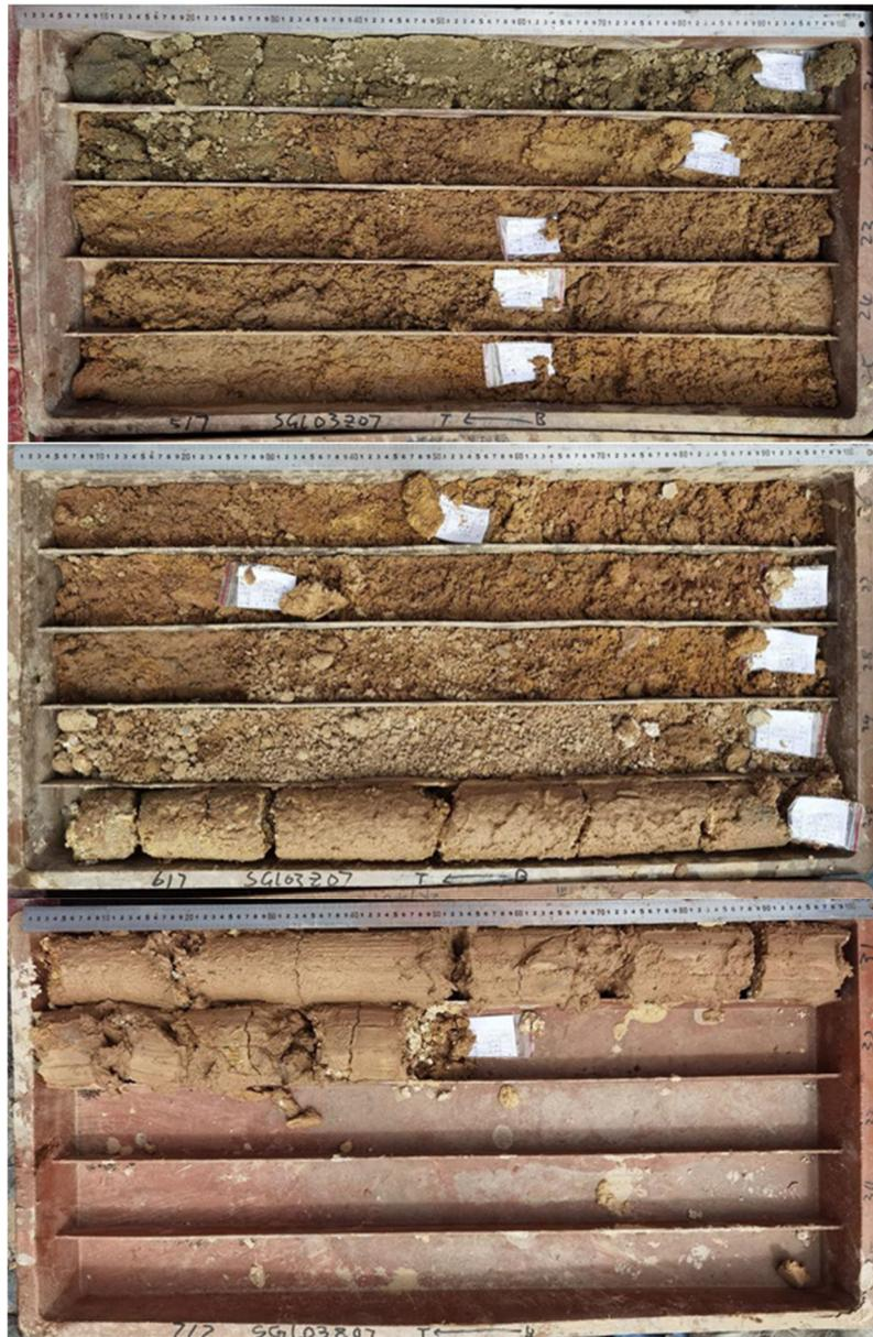
图 3.1.3.2-3 钻孔 SGL03Z07 揭露的第三层中砂、粗砂、砾质砂层及底部风化层和花岗岩（孔深 20.0-31.4m）
