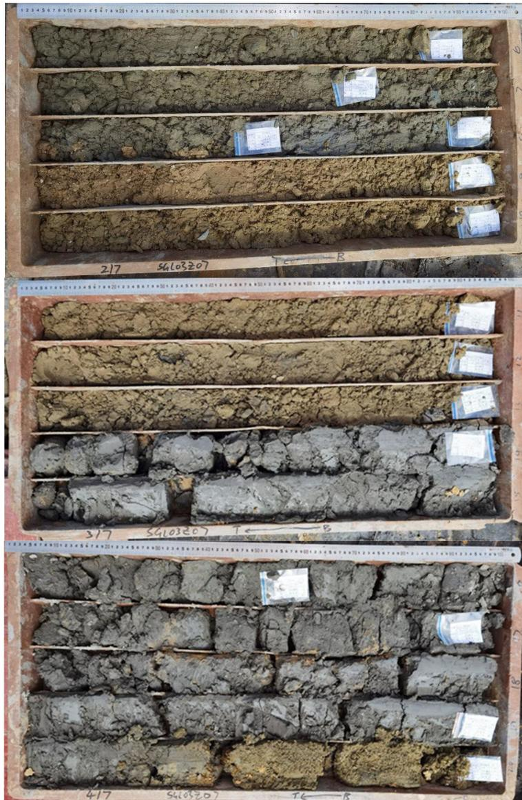
图 3.1.3.2-2 SGL03Z07 揭露的第二层粉砂、细砂层及粘土层（孔深 5.0-20.0m）
