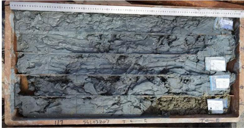
图 3.1.3.2-1 钻孔 SGL03Z07 揭露的第一层粉砂质淤泥层（孔深 0-5.0m）
