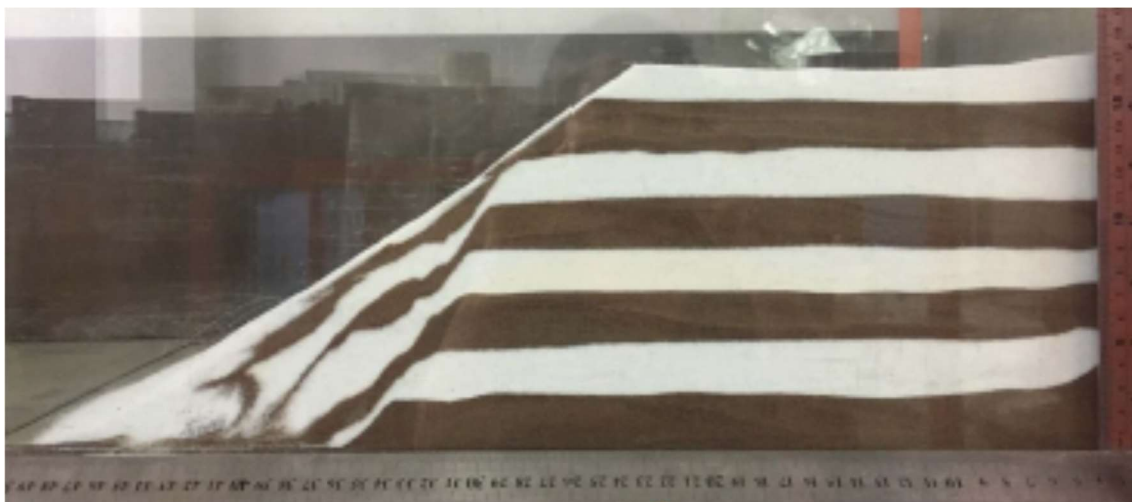
图 4.1.3.3-2d 采砂深度 17cm 实验照片
