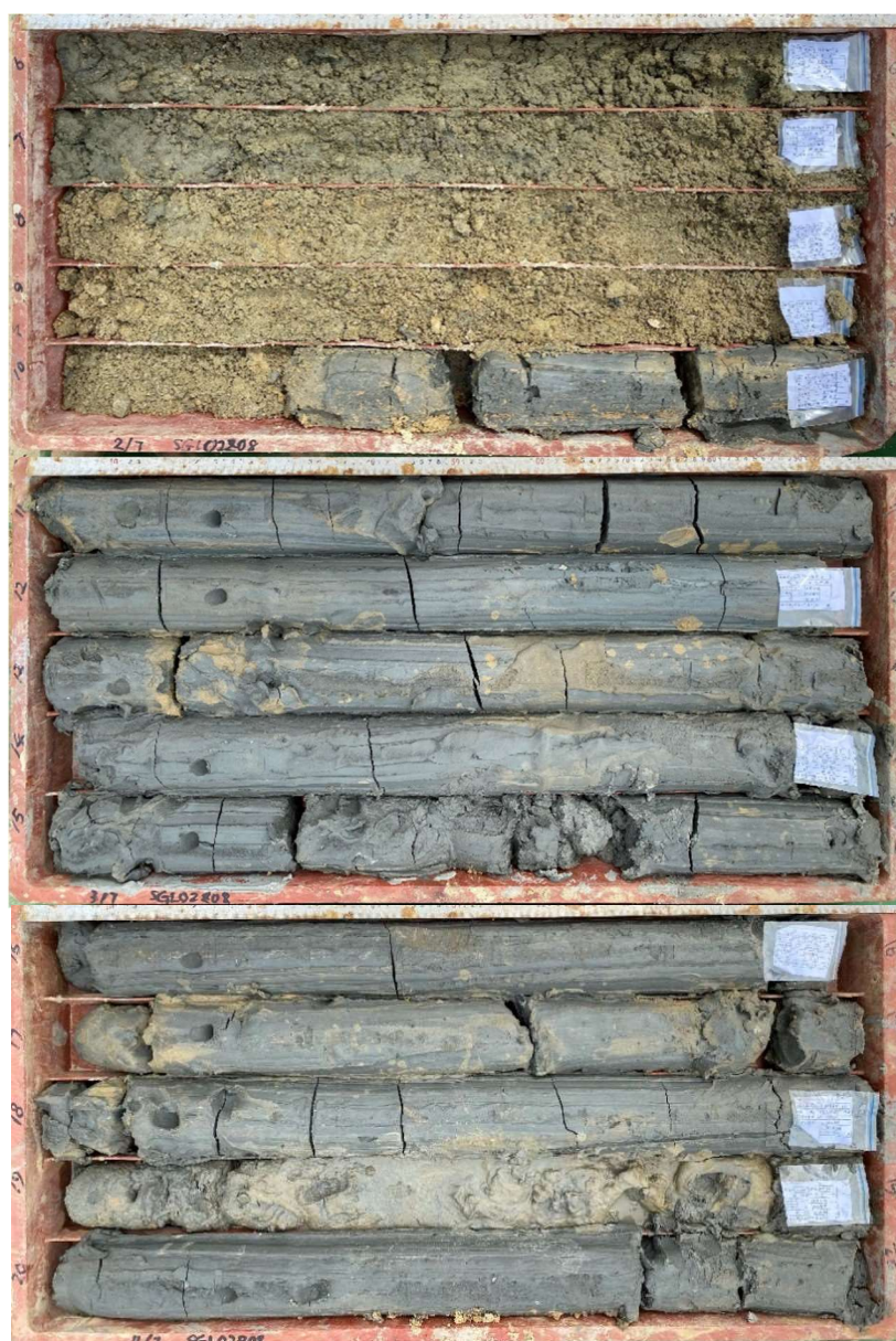
图 3.1.3.2-1 钻孔 SGL02Z08 揭露的第一层粉砂质淤泥层（孔深 0-5.0m）
