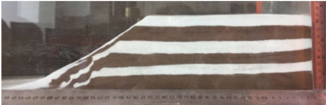
图 4.1.3.3-2b 采砂深度 11cm 实验照片
