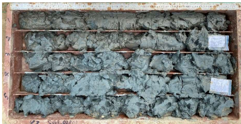
图 3.1.3.2-1 钻孔 SGL02Z08 揭露的第一层粉砂质淤泥层（孔深 0-5.0m）
