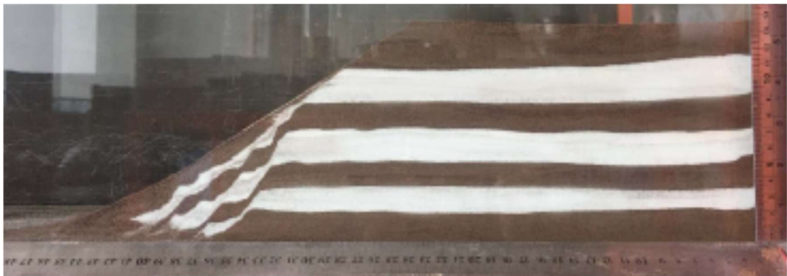
图 4.1.3.3-2c 采砂深度 14cm 实验照片
