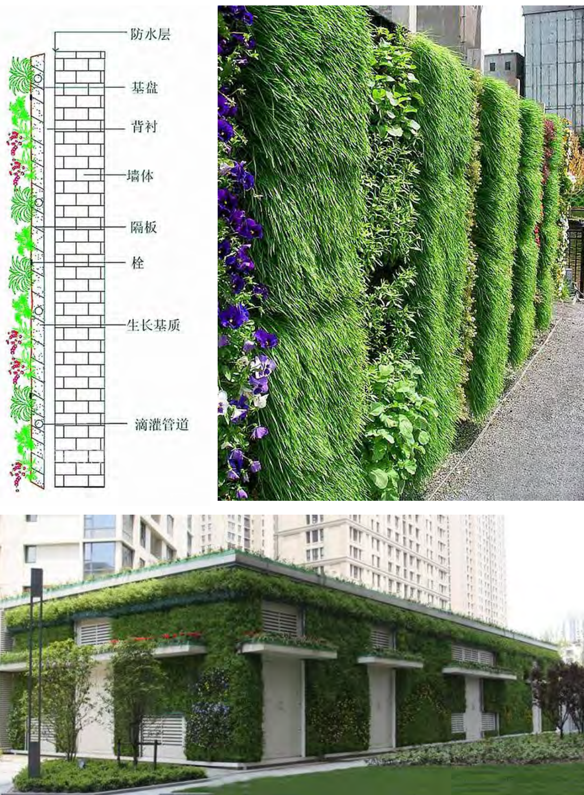
图 4-4 铺贴式墙面绿化图及施工示意图
