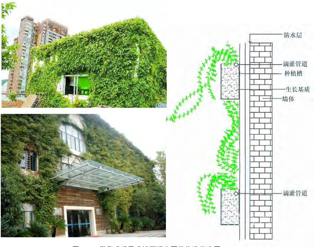
图 4- 1 攀爬或垂吊式墙面绿化图及构造示意图
