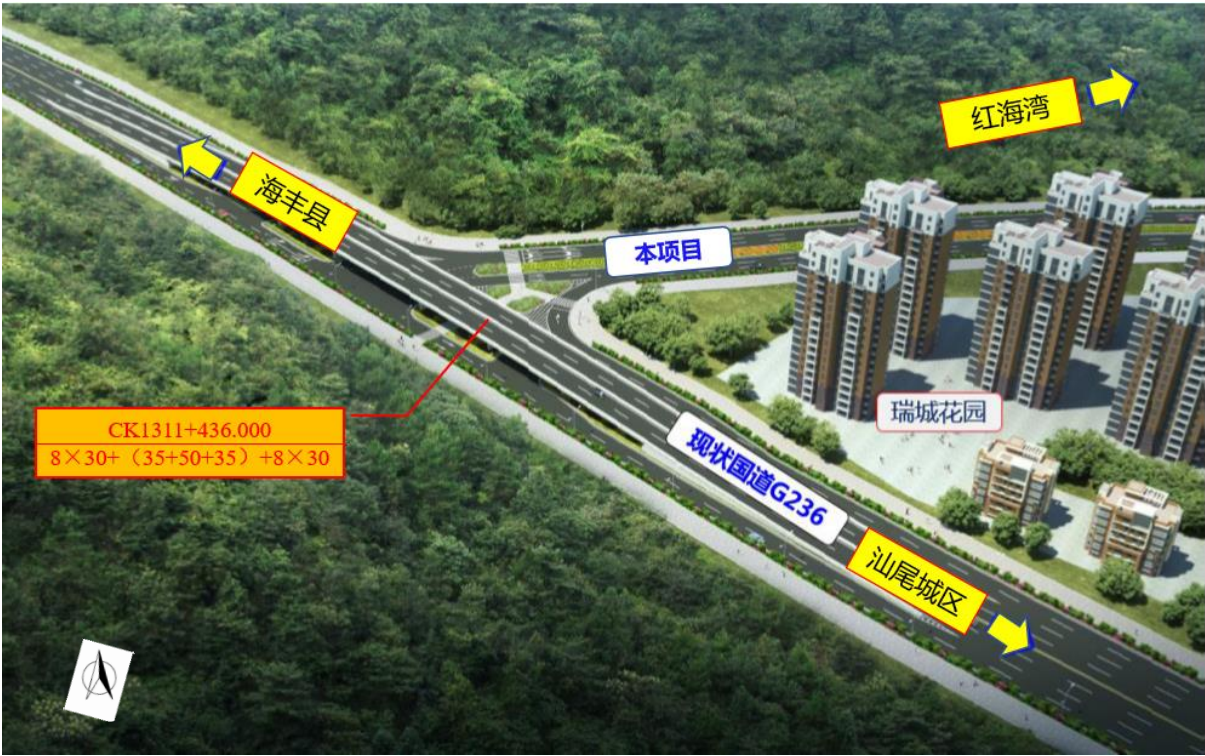
图 2.5-3 分离式立交平面布置示意图
