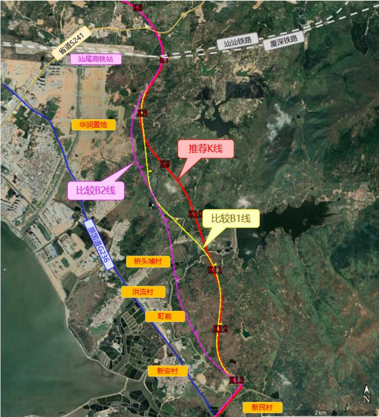
图 2.7-1 比选线位 B1 B2 示意图 表 2.7-1 初设同深度比选方案
